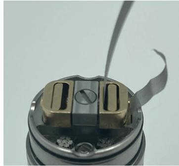
**Schneiden sie den Mesh schräg an und fädeln Sie den Mesh durch die Öffnung am Minuspol.**
