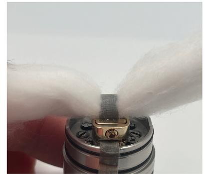
**Am Minuspol Schraube lösen, dann am Mesh ziehen um die Watte zu komprimieren.**
