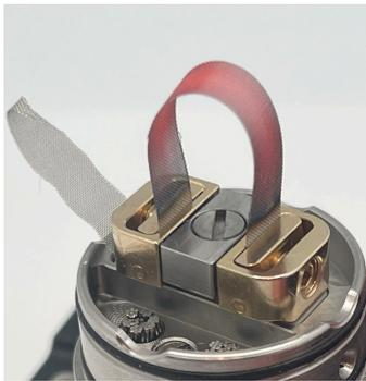
**Ziehen Sie beide Schrauben fest und glühen Sie bei niedriger Leistung aus.**
