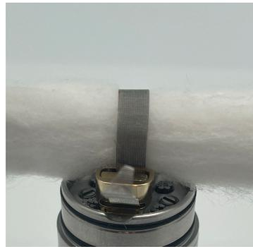
**Den Mesh am Pluspol lösen, Watte einlegen und wieder Pluspol festschrauben.**
