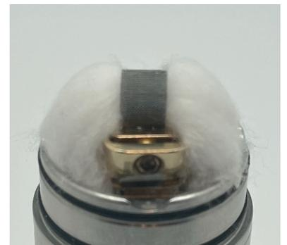
**Jetzt die Watte befeuchten und Tank befüllen.**
