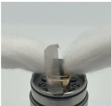
**Halten sie den Mesh fest und schrauben sie die Meshplatte fest. Die Watte abschneiden ca. 1cm überstehen lassen.**
